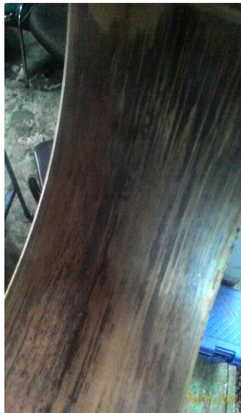
Gambar.5 Bantalan connecting rod mengalami keausan akibat kurangnya pelumasan.
