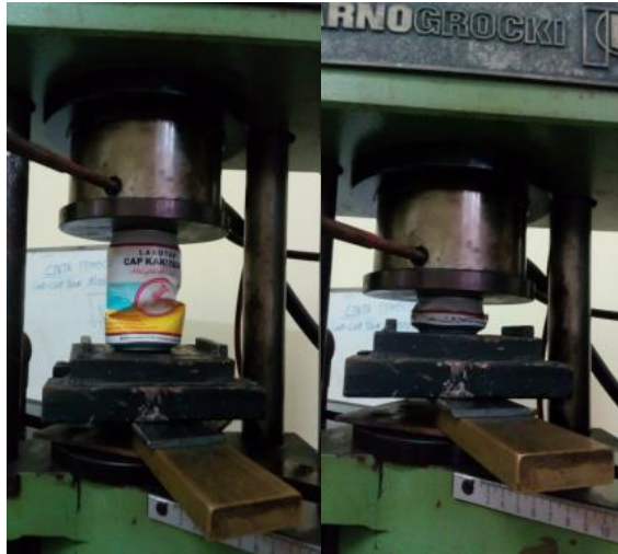
(Gambar 2 Proses press kaleng minuman dengan Alat Tarno Grocki)
