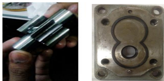
Gambar 4.2 serpihan crack pada gear pompa dan seal shaft yang longgar.
