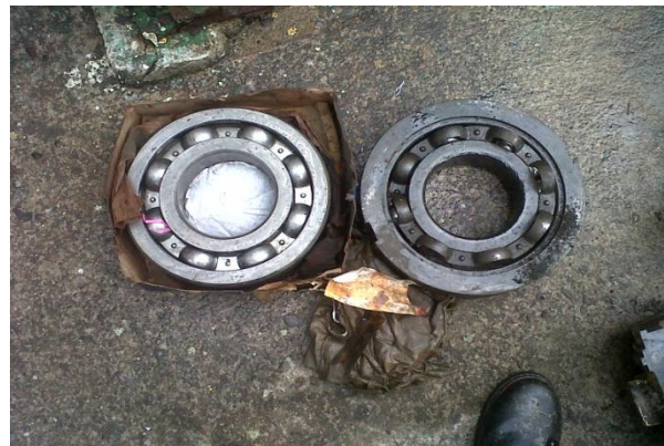
Gambar 3.3 penggantian bearing yang lama dengan yang baru
