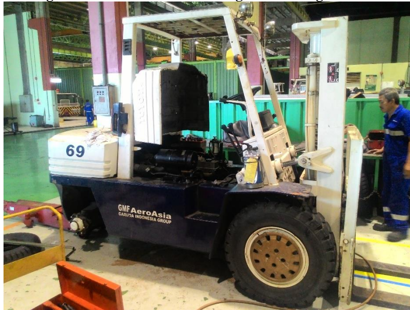
Gambar 5. Contoh Equipment Yang Rusak Dikarenakan Perawatan Yang Tidak Sesuai Dengan Prosedur
