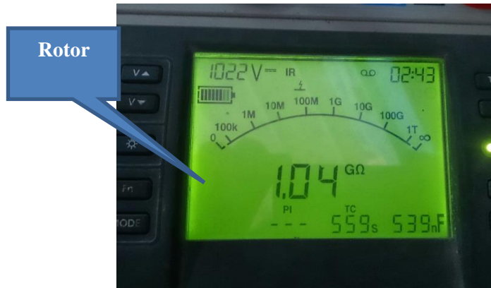
Gambar. 6 Megger Test Rotor
