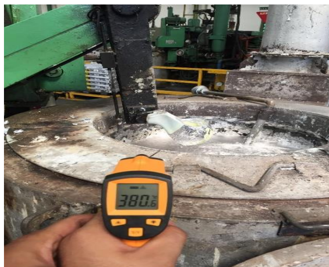
Gambar 3.4 Pengukuran Suhu Menggunakan Infrared Thermometer
