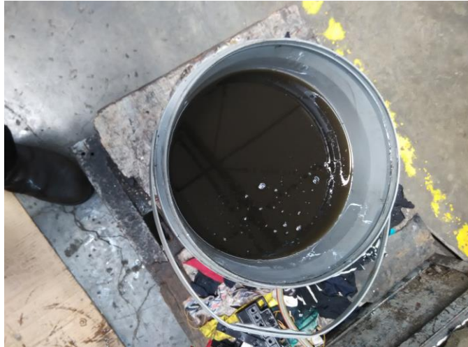
Gambar.2 Oli Hidraulik yang Encer dan Terkontaminasi
