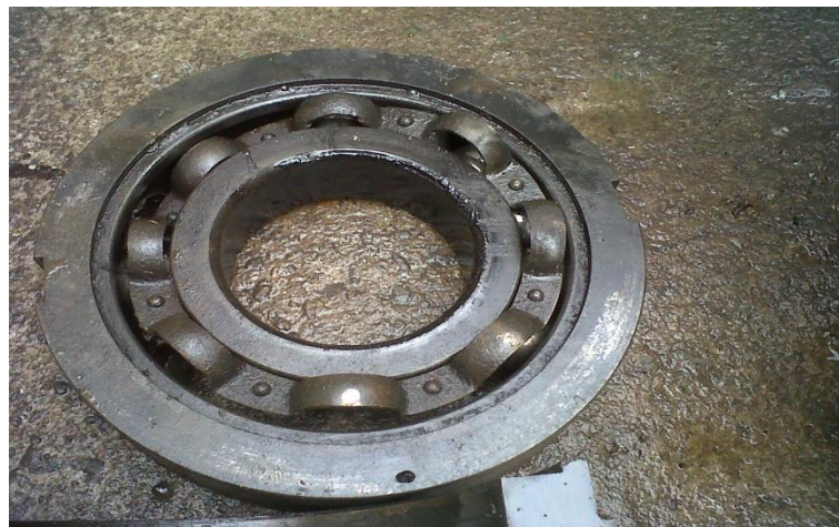
Gambar 3.1 Bearing pada pompa yang mengalami kerusakan
