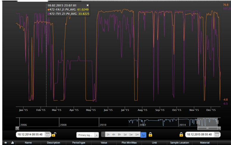
Gambar 1. Trend Power Consumption Motor (Jingga) Dan % Dumper (Ungu)
