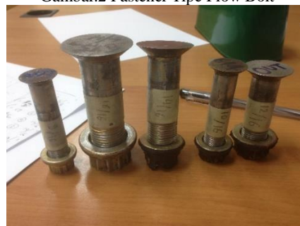
Gambar.3 Fastener pada Skin Pesawat Terbang
