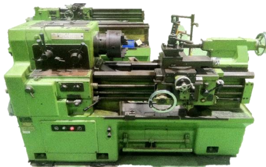
Gambar 3.1 mesin bubut Mori Seiki MS-650
