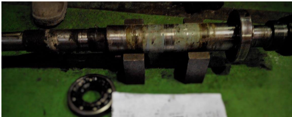
Gambar 3.1 kerusakan yang terjadi pada shaft
